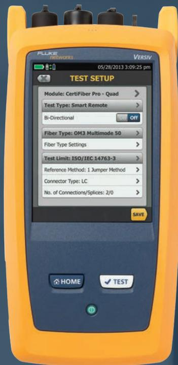
Mide atenuación, entrega un resultado de Pasa/Falla acorde a un estándar de Instalación (Backbone) y/o Aplicación (ej: Giga Ethernet). Analiza los resultados de las pruebas y genera reportes profesionales con información relevante con el software de gestión LinkWare.
