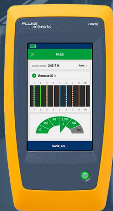
Comprobación gráfica del mapa de cableado y de la longitud para identificar los fallos más comunes que se producen con la instalación del cableado.
